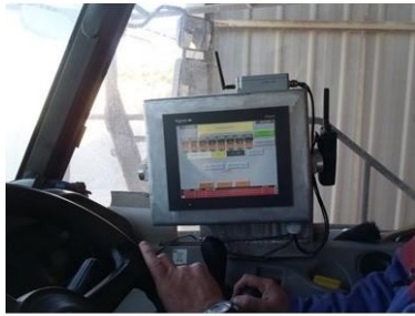
Commande de l'ouverture des trémies depuis la cabine du tombereau
